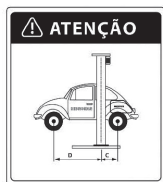
Fig. 1 - Veículos com motor traseiro devem ser posicionados de forma que a medida "C" seja menor que a "D".
