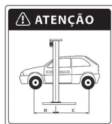
Fig. 1 - Veículos com motor traseiro devem ser posicionados de forma que a medida "C" seja menor que a "D".
